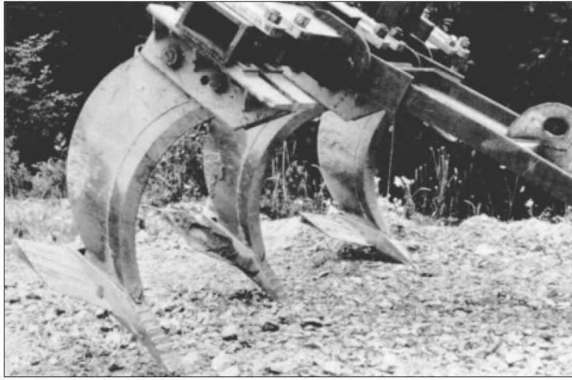
Şekil 6. Üretim sonrası sürütme şeridi toprağının ripperle alt üst edilmesi (Adams, 1998).
