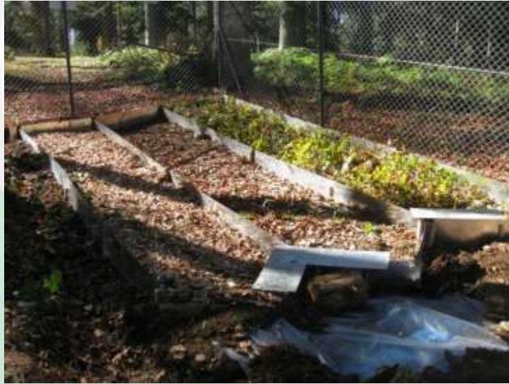
Şekil 4. Sürütme şeritleri üzerine kesim artıklarının ve yonganın serilmesi (Düzce Yöresi)
