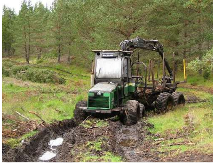
Şekil 9. Bölmeden çıkarma çalışmasındaki toprak zararları
