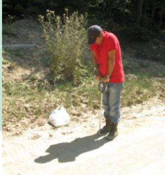
Şekil 2: Penetrometre ile yapılan ölçümler
